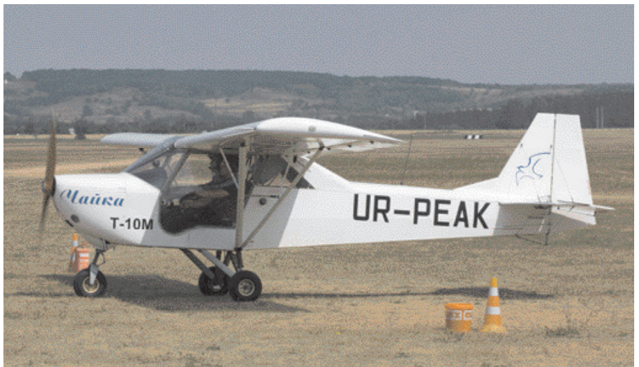
Die ukrainische T-10M Möwe wird von einem Rotax-912-Motor mit 74 KW angetrieben.
